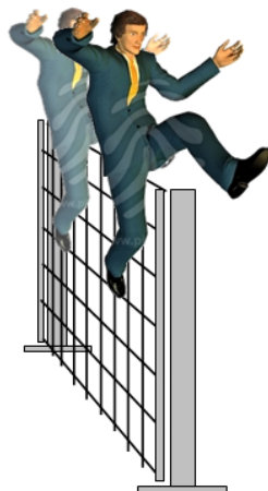
Bild 3: Vertikalbelastung durch Überklettern
